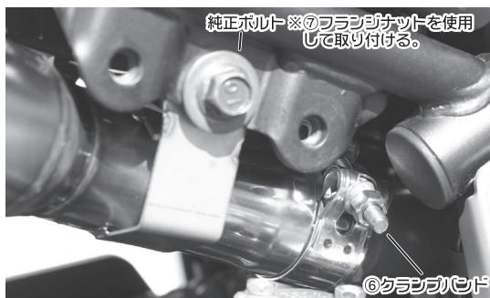
5. サイレンサーを取り付けます。純正ボルトを使用して仮止めして下さい。
