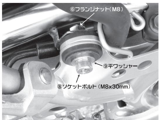
6. サイレンサーを取り付けます。⑥フランジナット（M8）,⑦ソケットボルト（M8x50mm）,⑨平ワッシャーを使用して仮締めして下さい。
