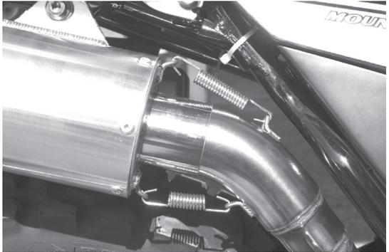
⚠ ベンチ、ブライヤ類の使用は走行中スプリング破断の原因となります。
