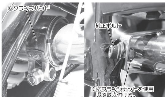
5. サイレンサーを取り付けます。純正ボルトを使用して仮止めして下さい。
