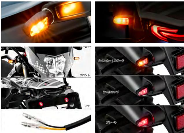
フロント、リア共に使用可能。配線は汎用性の高い2線式でギボシ加工済み。
