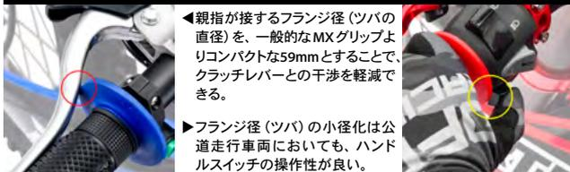
◀親指が接するフランジ径(ツバの直径)を、一般的なMXグリップよりコンパクトな59mmとすることで、クラッチレバーとの干渉を軽減できる。
