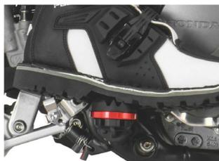
▲ワイドなゴムカバーは車体からの振動を吸収し、ロングツーリングでライダーへの疲労を大幅に軽減。
