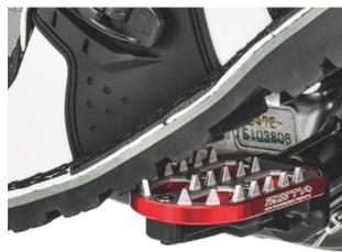
▲ステンレスブレードは靴底への食いつきがよく、泥やウエットコンディションでも滑りにくい。ステンレス製の歯(ブレード)は錆びにくく耐摩耗性にも優れる。
