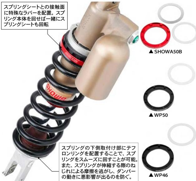
純正のスプリングシートとスプリングの間に挟むだけで、作業効率が向上。リヤショックへのアクセスが厳しい車両でも、特別な工具を使うことなく、手でスプリング本体を回すだけで簡単に調整可能。樹脂製のスプリングシートを破損することなく、大変だったプリロード調整を容易にする。
