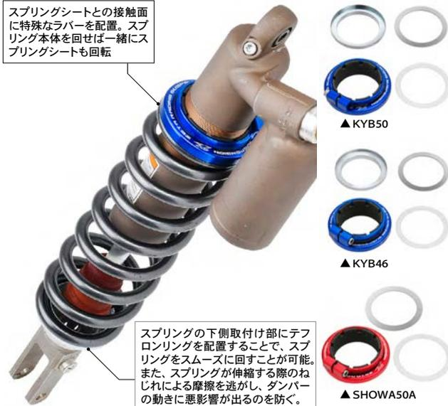
純正のロックナットとスプリングシートを交換するだけで、大変だったスプリングのプリロード調整を容易にする。ロックナット方式ではなく、WP等でも用いられているバンド方式を採用。5mmの六角レンチでロック・解除が可能。プリロード調整をする際に何度も叩き込む必要はなく、車体に付いた状態でもスプリング本体を手で回すだけで簡単に調整可能。
