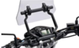
エクスプローラーハンドルバーのブレースにアームを取付ける。マウントバーを最大限に利用できる組み合わせ。スタンダードスクリーンを標準装備。
