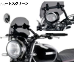
ハンドルバーに専用アダプターを装着し、アームを取付ける。スタンダードスクリーンタイプと、ショートスクリーンタイプをラインナップ。
